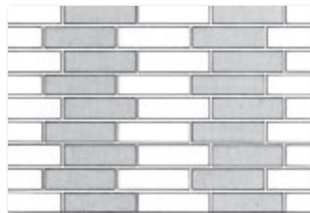
Ложковая перевязка со сдвигом на кирпича по вертикали
